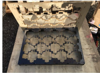
写真6 天板を外した6 mm厚補強板と金属枠
